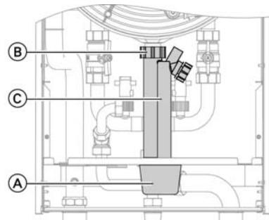
1. Снять колпачок **A**, потянув вниз.
