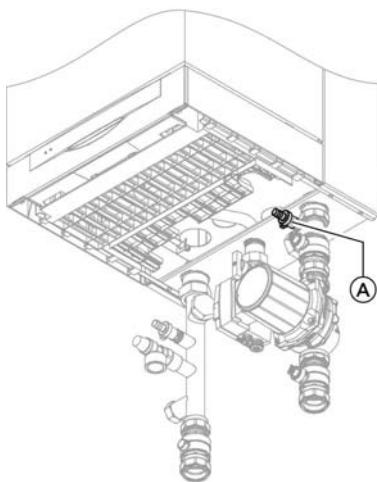
1. Проверить входное давление мембранный расширительного бака.
