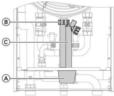
1. Снять колпачок **(A)**, потянув вниз.
